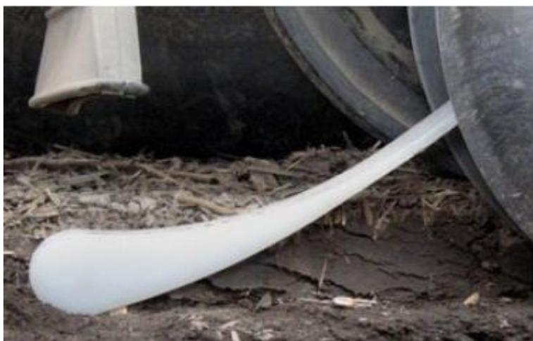
*La languette anti-rebond permet de positionner la graine au fond du sillon et assure son contact avec le sol. Dans le cas des semoirs à transport pneumatique des graines, elle permet de maintenir les graines dans le sillon.*
